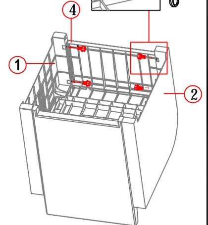
**7** 背もたれ固定ボルト (4本締め) をきつく締めます。締めた後、背飾りを組み立てます。
