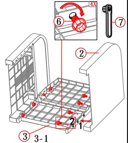
\*ボルトで仮止めしてください。きつく締めると4以降の作業ができなくなります。
