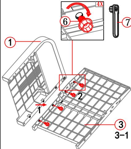
\*ボルトで仮止めしてください。きつく締めると4以降の作業ができなくなります。
